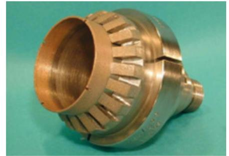
Gesintertes Kombinationswerkzeug zum Bohren und Fasen
