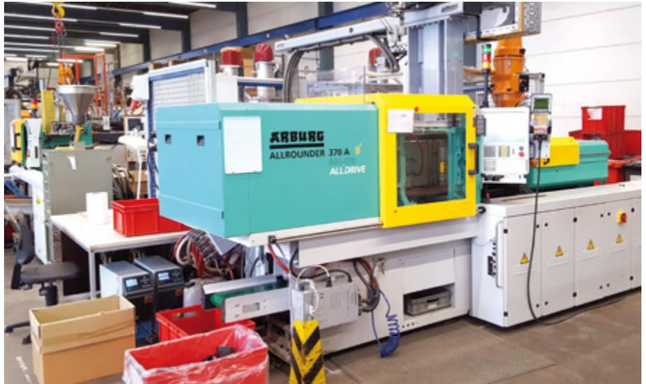
In der Produktion nutzt Maul unter anderem die vollelektrische Maschine Arburg 600kN
