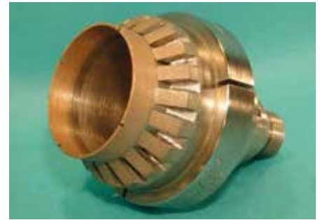
Gesintertes Kombinationswerkzeug zum Bohren und Fasen
