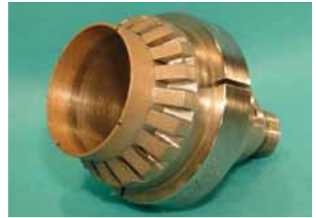
Gesintertes Kombinationswerkzeug zum Bohren und Fasen
